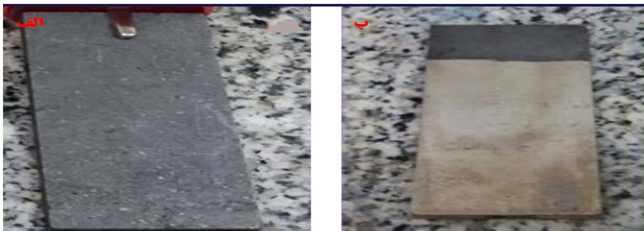
تصویر ۳. تصاویر واقعی الکتروود گرافیت؛ الف، قبل از اصلاح (GP)؛ ب، بعد از ترکیب نیکل (Ni@GP)
