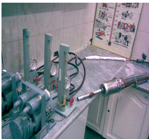
شکل ۵- سیستم شبیه سازی گاز خروجی
