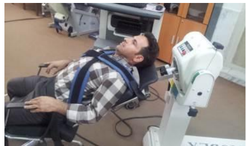
شکل ۲. نحوه قرار گرفتن داوطلب روی ابزار الحاقی طراحی شده جهت بایودکس مدل Pro4 برای اندازه‌گیری گشتاورهای چرخشی تنه
