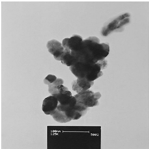
شکل ۲. تصویر TEM از نانوذرات اکسید روی و ناخالصی منیزیم با درصد اتمی ۷٪
