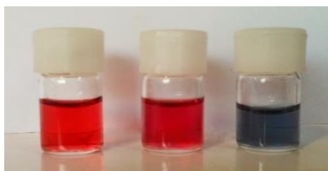
شکل ۲. الف) نمودار طیف جذب نانو ذره طلا، منحنی (A) نانوذره طلا سنتز شده، منحنی (B) نانو ذره طلا اصلاح شده با MUA، منحنی (C) نانو ذره طلا اصلاح شده با EDC/NHS، منحنی (D) نانو ذره طلا کونژوگه شده با آنتی بادی. ب) نمایش تغییر رنگ در مراحل مختلف ساخت، شکل (A) نانو ذره طلا سنتز شده، شکل (B) نانو ذره طلا اصلاح شده با MUA، شکل (C) نانو ذره طلا اصلاح شده با EDC/NHS و کونژوگه شده با آنتی بادی
