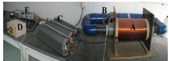
تصویر ۱: انکوباسیون متصل به دستگاه مولد میدان الکترومغناطیسی A؛ بوبین، B؛ سیستم انکوباسیون، C؛ (نوسا)، D؛ فان، E؛ ولت سنچ
